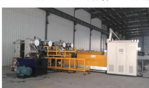
混杂废塑料挤注成型设备
